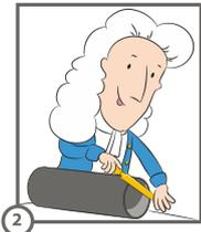
**2** - Снимите фаску под углом 15° таким образом, чтобы, по крайней мере, 50% толщины стенок было снято с передней кромки. Для выполнения этих действий можно использовать соответствующие фасочные резцы, рашпиль или напильник.
