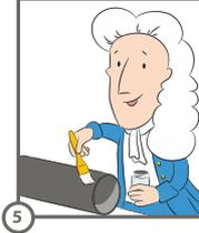
**5** - Нанесите клеящее вещество ровным слоем на продольные поверхности обеих соединяемых частей (наружную поверхность трубы и внутреннюю поверхность фитинга) с помощью аппликатора или грубой кисти соответствующих размеров. Клей должен быть нанесен на всю длину склеиваемых поверхностей.
