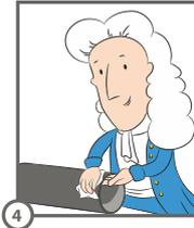
**4** - Обезжирьте внешнюю поверхность гладкого конца трубы и внутреннюю часть фитинга с помощью бумажной или тканевой салфетки, пропитанной очистителем для ПВХ труб. Важно, чтобы обе сопряженные поверхности были чистыми. Просушите поверхности в течение нескольких минут.
