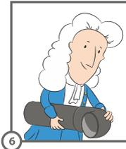
**6** - Быстро вставьте трубу в фитинг на всю глубину соединения, не вращая ее. Только после этого можно слегка повернуть оба края (не более оборота трубы и фитинга). При повороте компонентов нанесенный клей распределяется еще более равномерно. Выдавлившиеся излишки клея удалите тряпкой и в течение 30 с, пока клей схватится, удерживайте детали неподвижно.
