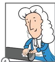
Обезжирьте внешнюю поверхность гладкого конца трубы и внутреннюю часть фитинга с помощью бумажной или тканевой салфетки, пропитанной очистителем для ПВХ труб. Важно, чтобы обе сопряженные поверхности были чистыми. Просушите поверхности в течение нескольких минут.
