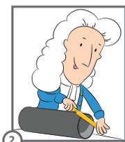
Снимите фаску под углом 15° таким образом, чтобы, по крайней мере, 50% толщины стенок было снято с передней кромки. Для выполнения этих действий можно использовать соответствующие фасочные резцы, рашпиль или напильник.
