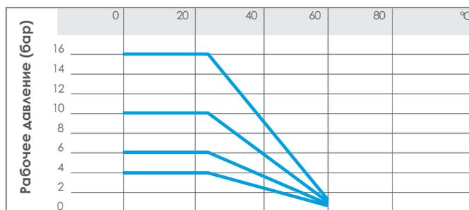
график изменения давления в зависимости от температуры для воды и сред, в отношении которых ПВХ классифицируется как химически стойкий
