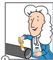
Нанесите клеящее вещество ровным слоем на продольные поверхности обеих соединяемых частей (наружную поверхность трубы и внутреннюю поверхность фитинга) с помощью аппликатора или грубой кисти соответствующих размеров. Клей должен быть нанесен на всю длину склеиваемых поверхностей.
