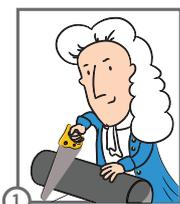
Отрежьте трубу перпендикулярно оси. Резку труб выполняют труборезами, ножовками для резки пластика или мелкозубыми ручными пилами. Разрез должен быть прямым, для этих целей рекомендуется использовать угольник или схожие устройства. В противном случае, прямой разрез можно сделать с помощью бумаги, обернув ею трубу.
